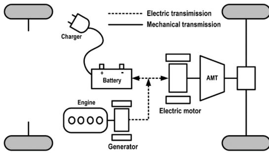
Fig. 1: PHEV scheme.
